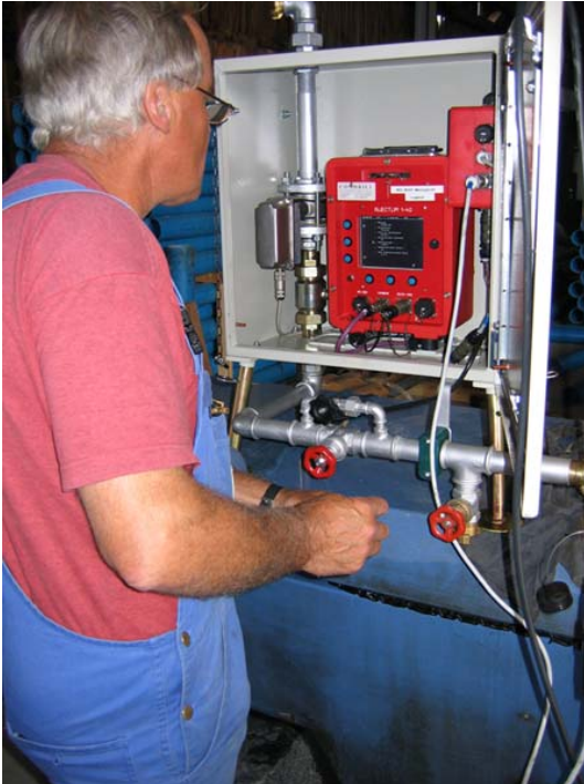
Druck-/Mengenmessgerät Injektlim 4G im Einsatz
